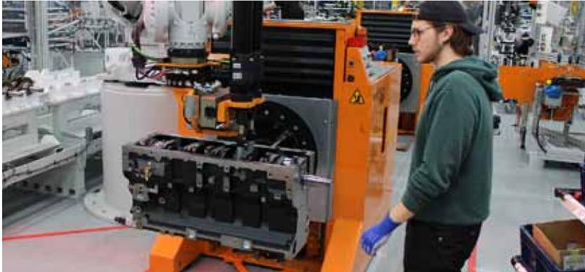
Assisté d'un robot industriel, le mécanicien Julius Salmela installe un vilebrequin sur un moteur six cylindres.
