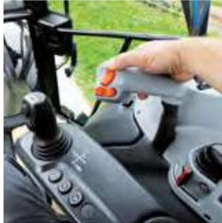
Ces deux boutons servent à sélectionner les rapports et les gammes sous charge. La «Hitech-4» offre 4 rapports et 4 gammes de changement de vitesse sous charge.
