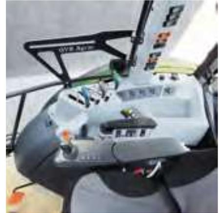
Le joystick progressif pour le chargeur frontal ou le relevage intégré dans l'accoudoir est réglable et peut s'utiliser tout en finesse.
