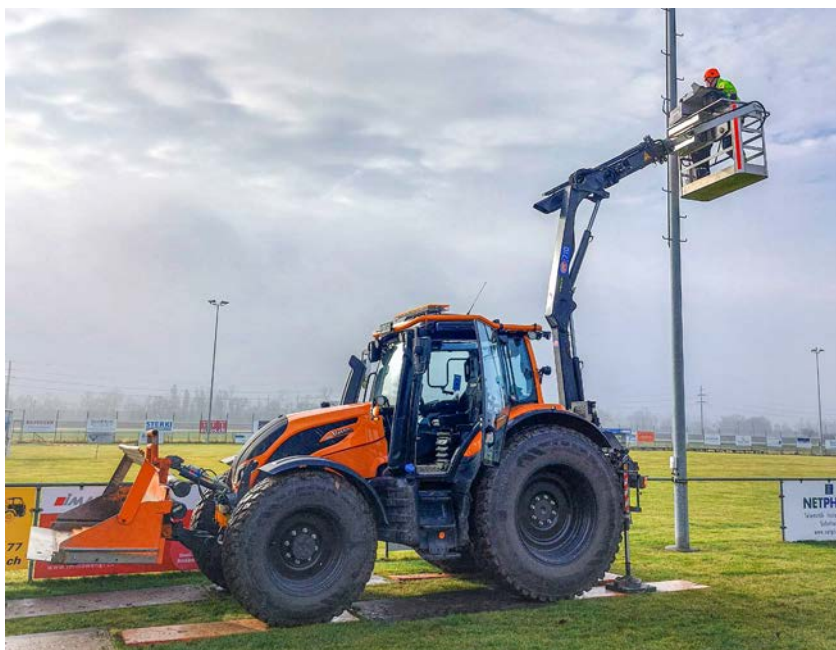
La grue arrière avec nacelle permet de travailler en toute sécurité jusqu'à sept mètres de hauteur.
